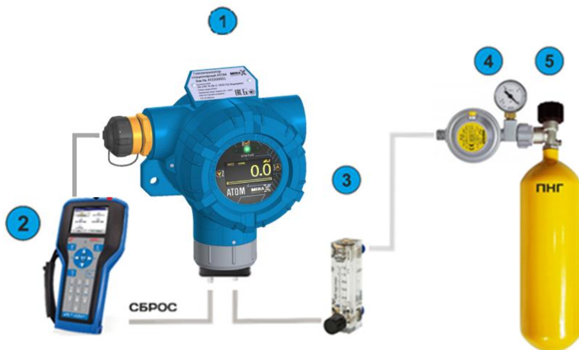
Рисунок 41 – Комплект для калибровки нуля при помощи HART-коммуникатора
