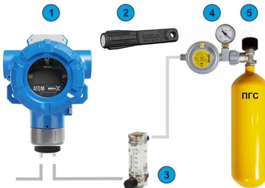
Рисунок 40 – Комплект для калибровки чувствительности магнитным ключом
